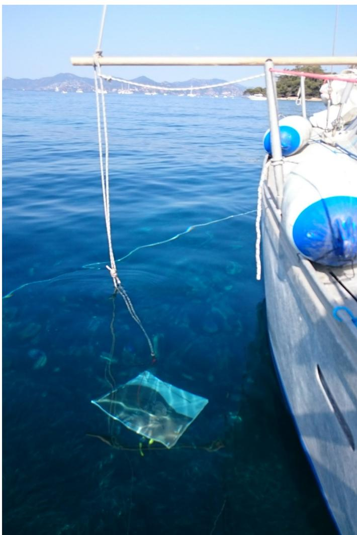
*Figura 22: Smorzatore del rollio improvvisato con materiale recuperato a bordo*
